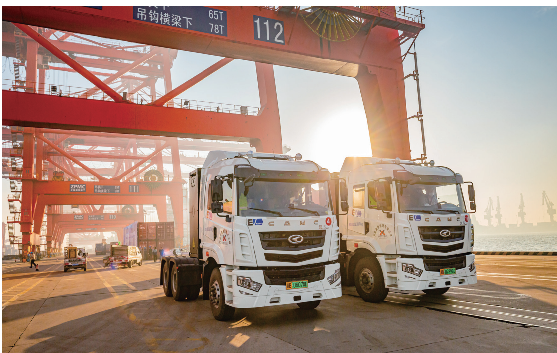
在港口作业的换电重卡。
